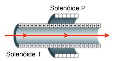
Solenóide 1 de raio de interno  $R_1$ , comprimento l e com  $N_1$  espiras Solenóide 2 de raio de interno  $R_2$ , comprimento l e com  $N_2$  espiras
