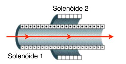
Se pelo solenóide 1 passa uma corrente  $I_1$  e pelo solenóide 2 passa uma corrente  $I_2$
